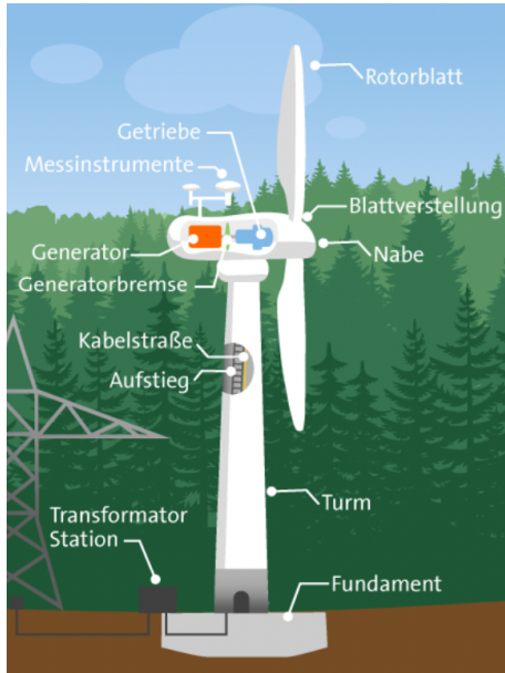
Abb. 3.8.: Aufbau eines Windrades
